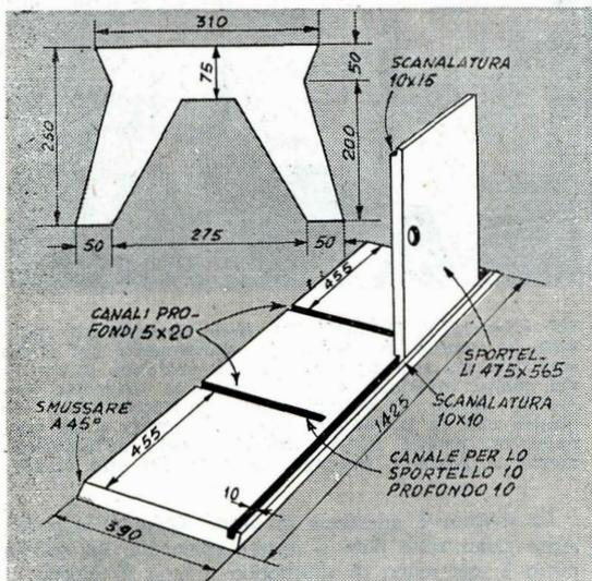
**IL TAGLIO** dei giunti a unghia deve essere accuratissimo. Se usate una sega circolare a piano inclinabile, regolatelo a 45°, poi fate una prova ponendo un telaio quadrato intorno a due pezzi passati alla lama: se il giunto non è perfetto, correggere l'inclinazione (vedi pag. precedente a sinistra).
