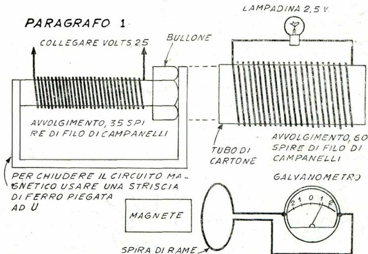
Consideriamo ora il funzionamento di un trasformatore: in questo si vedono, è vero, gli avvolgimenti di filo di rame isolato, ma non c'è nessun magnete né si vedono parti in movimento. Com'è possibile dunque che nell'avvolgimento secondario che — come dimostrato con l'esperimento 1.0 — non ha alcun contatto con l'avvolgimento sotto tensione, si generi una corrente elettrica?
