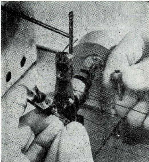
tone dello stesso spessore del tubo. Se fossero saldate ad argento, null'altro occorrerebbe. Usando una saldatura dolce, invece introdotte le testate un po' nell'interno e ribattete su di loro le estremità del tubo. Un tondino filettato di rame o di ottone, passato per il loro centro e bloccato da dadi ad ambedue le estremità garantirà alla caldaia una solidità a tutta prova. Quando saldate le testate, assicurate i dadi avvitando delle viti.
