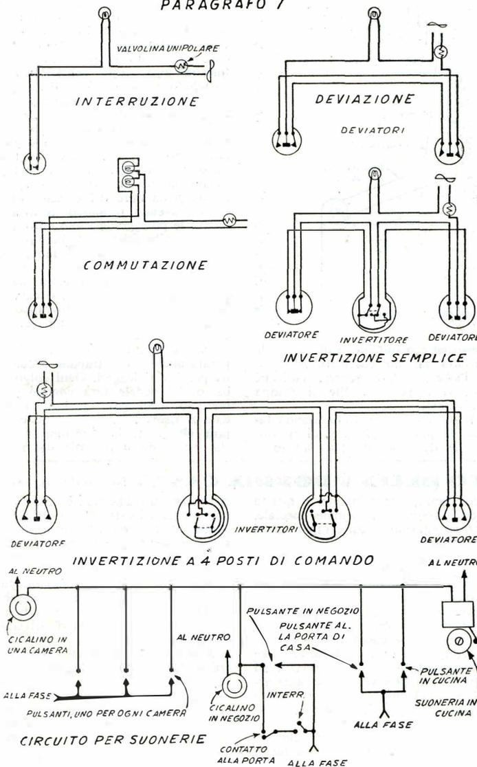
Riproduco pure un circuito per suonerie che presenta particolari vantaggi: infatti con un solo filo di linea è possibile far funzionare una o più suonerie con uno o più pulsanti; inoltre, utilizzando lo stesso circuito, potete realizzare un pratico ed efficiente dispositivo d'allarme antifurto.
