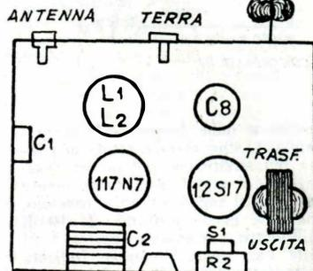
Questi due apparecchi sono costruiti con le medesime valvole: usano cioè una 6SJ7/12SJ2-GT, oppure a tubo metallico, in AF (preferibile il tipo a tubo metallico) ed una 117N/M/L/A7-GT, indifferentemente, come amplificatrice e raddrizzatrice.
