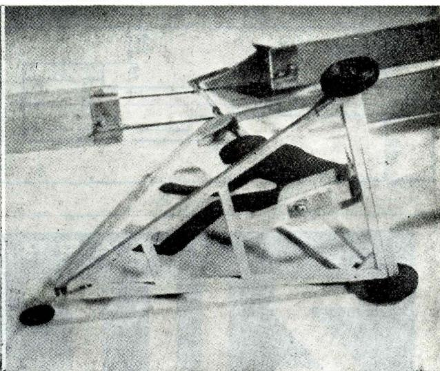
L'albero dei rotori è fisso, con un clip di metallo saldato al vertice per la pinna, mentre i rotori debbono girare senza attriti. Il filo che sorregge le pale del rotore superiore è piegato in modo da formare un die-
